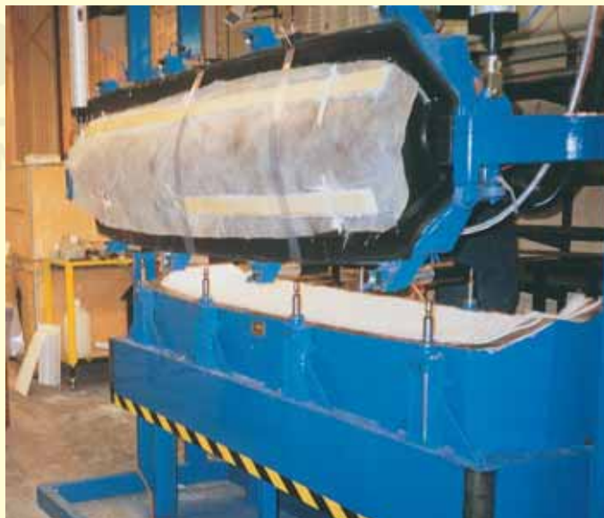
Estação de moldagem parasol Mercedes-Benz com molde eletroformado - ano de 1996
