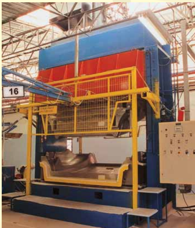
Estação de moldagem do capô Ford F12.000 / 14.000 - 1997
